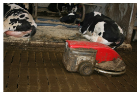
Рисунок 4. – Уборка навоза со щелевого пола с использованием робота
