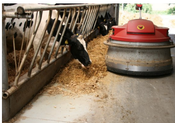
Рисунок 5. – Подгребание роботом корма на кормовом столе
