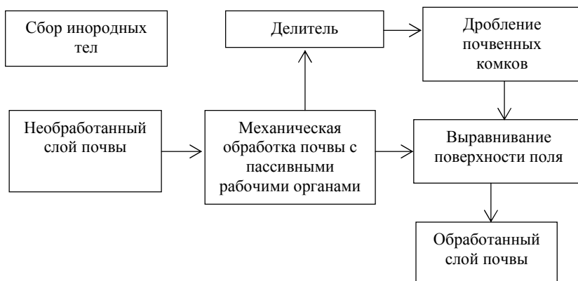
Рисунок 2. – Схема технологического процесса усовершенствованного орудия для предпосевной обработки почвы
