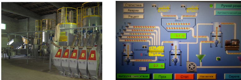
Рисунок 1. – Общий вид комплекта оборудования для производства добавок на основе рапсового жмыха КДР-0,8 и панель управления оператора.
