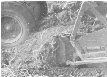
Рисунок 1. – Сгруживание подкапываемой грядки на лемехе картофелеуборочной машине
