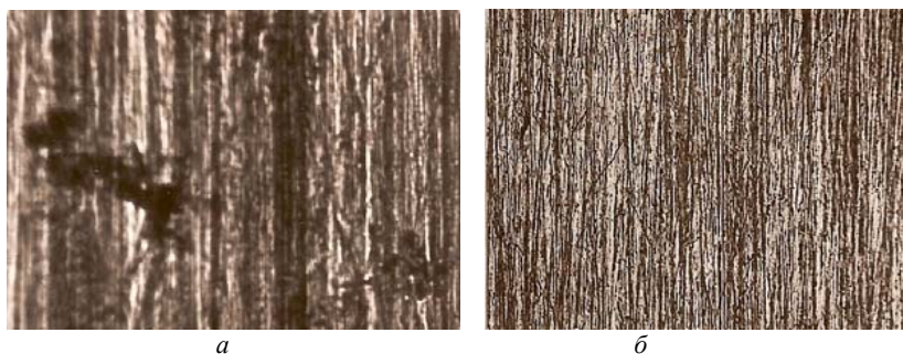
Рис. 3.9. Фотографии поверхности стали 30X15 после обработки: а – шлифование; б – МАО, \times 100
