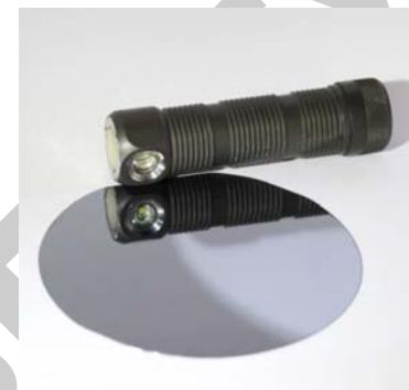
Рис. 4.18. Фотография металлооптического элемента после МАО
