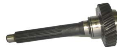
Рис. 4.60. Зубчатое колесо АДП – 130 – 1700 – 103 (а), вал первичный АДП – 130 – 1700 – 101 (б) коробки передач автомобиля ЗИЛ – 130
