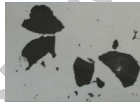
Рис.3.17. Фотография частицы порошка после модифицирования индивидуальным магнетитом, олеиновой кислотой и полимером \times 100
