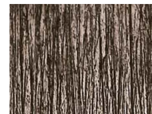
Рис. 4.31. Топография поверхности закаточных роликов после использования MAO, \times 100
