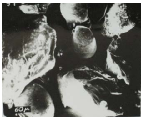
Рис. 3.19. Фотография частиц ФАПД-1, полученных в дуговой азотной плазме \times 100
