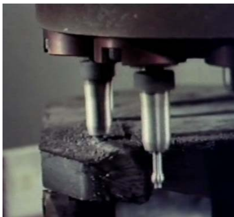
Рис. 4.35. Зона обработки рукояток управления коммутационной аппаратуры на станке MAPC-15
