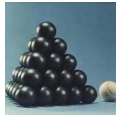
Рис. 22. Топливо PBMR-реактора
