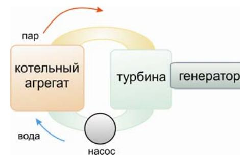
Рис. 5. Упрощенная схема электростанции
