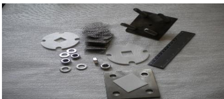
Рисунок 2. Разобранный экспериментальный образец фильтроэлемента из ФМТС
