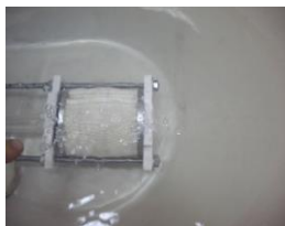
Рисунок 3. Определение максимальных размеров пор на штатном фильтроэлементе (а) и фильтроэлементе из ФМТС (б)
