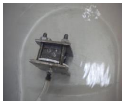
Рисунок 3. Определение максимальных размеров пор на штатном фильтроэлементе (а) и фильтроэлементе из ФМТС (б)
