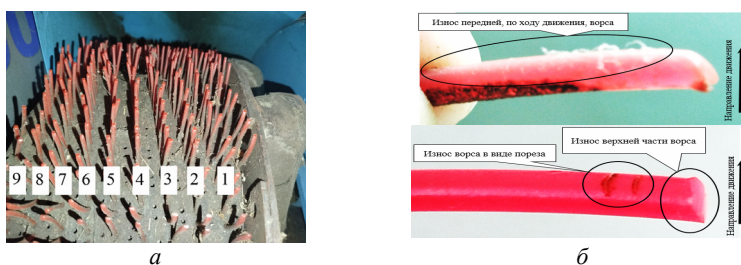
Рисунок 1 – Вычесывающий барабан роторно-бельного аппарата. а – вид вычесывающего барабана спереди; б – виды износа ворса роторно-бельного аппарата
