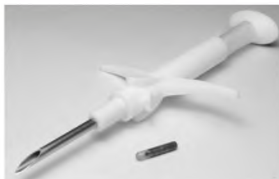
Рисунок 5 – Инъекционный микрочип в капсуле для идентификации лошадей (по СТБ/ПР_1)
