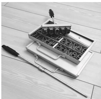
Рис. 2. Прибор для таврения животных ПТЖ-5
