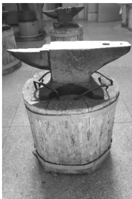
Рис. 3.4. Внешний вид рабочего места кузнеца с однорогой наковальней
