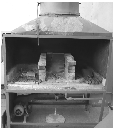
Рис. 3.3. Внешний вид горна открытого типа на твердом топливе
