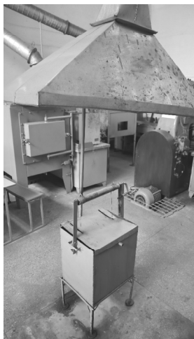
Рис. 3.5. Внешний вид ванны для термической обработки поковок
