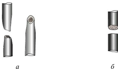
Рис. 2.4. Место разрушения образца: а – в виде кратера; б – по плоскости поперечного сечения
