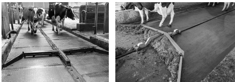
Рис. 7.2. Вид рабочего процесса скреперной установки
