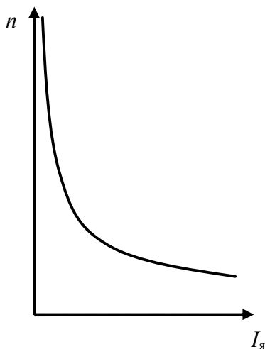
Рис. 8.3. Скоростная характеристика двигателя последовательного возбуждения
