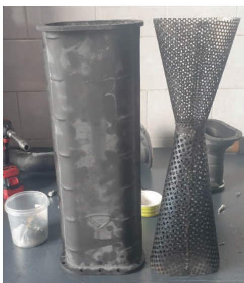
Рисунок 2 – Экспериментальный глушитель 800-1205100 в разборе
