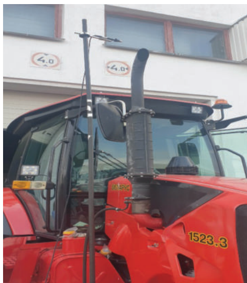
Рисунок 1 – Трактор «Беларус-1523.3» с экспериментальным глушителем
