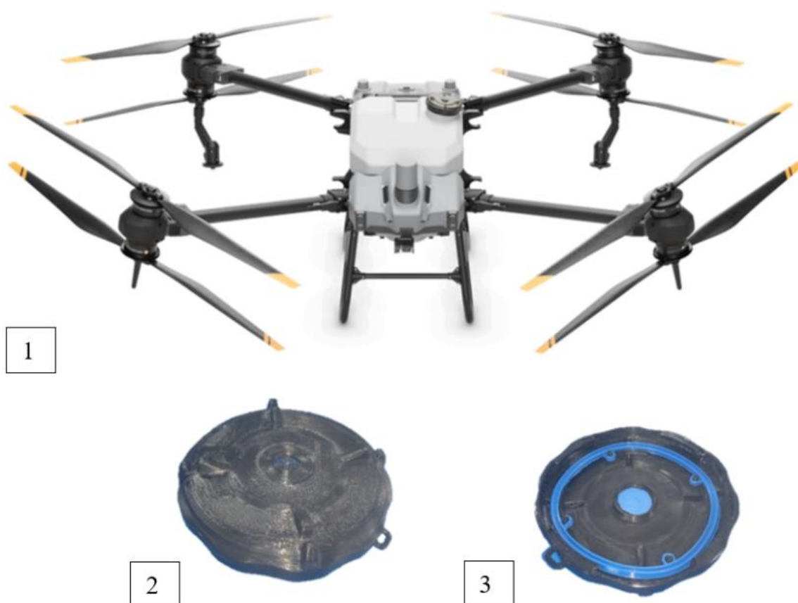
1 – общий вид агрономического дрона AGRAS T40, 2 – крышка в сборе вид сверху, 3 – крышка в сборе вид снизу
