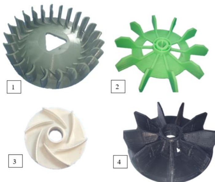
1 – крыльчатка охлаждения на маховик для двигателей, 2 – крыльчатка пластиковая для компрессора, 3 – крыльчатка охлаждения водяного насоса, 4 – крыльчатка охлаждения электродвигателя
