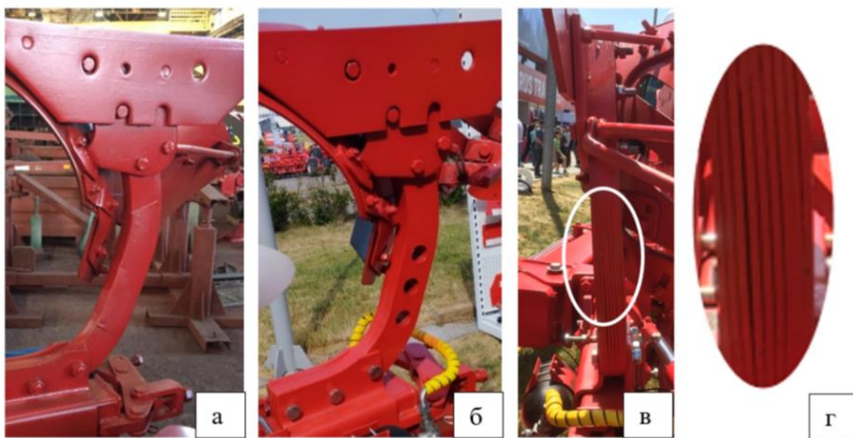
Рис. 4 – Грядиль плуга с традиционной конструкцией (а) и с модифицированной многослойной конструкцией (б, в, г), изготовленной с использованием SL-технологии (грядиль находится в составе плуга)
