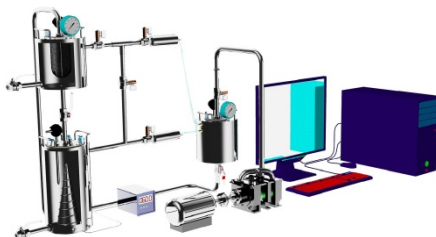
Рисунок 3 – 3D-модель универсальной вакуумной экстракционно-выпарной установки
