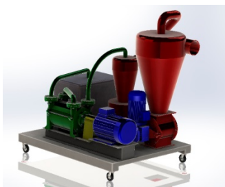
Рисунок 2 – 3D-модель вакуум-транспортной установки
