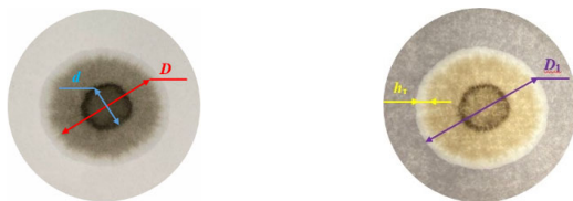
Рисунок 1 – Измеряемые величины для расчета ДС и наличия топлива в масле
