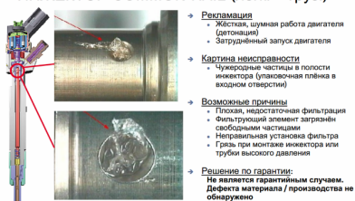
Рисунок 10 (а, б, в, д). Выдержки из каталога неисправностей CRIN2
