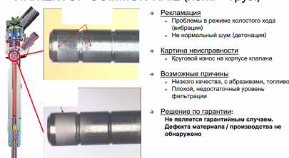
Рисунок 10 (а, б, в, д). Выдержки из каталога неисправностей CRIN2
