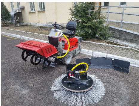
Рисунок 2 – Самоходная машина для обслуживания кормового стола с рядом сменных адаптеров
