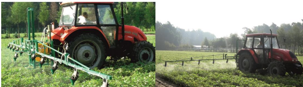
Рис. 7. Опрыскиватель Micromax с роторным распылителем [16]
