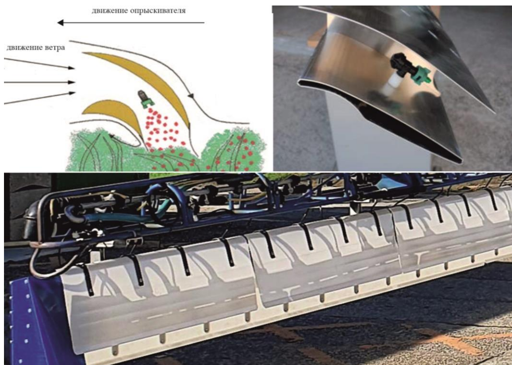
Рис. 6. Штанга фирмы Wingssprayer с системой Double Wing [15]
