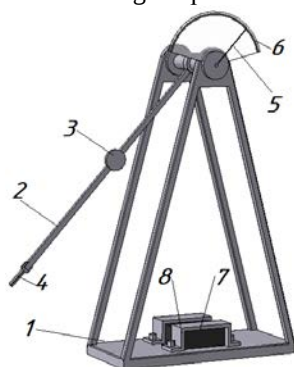
Рисунок 1 - Схема установки для исследования процесса резания
