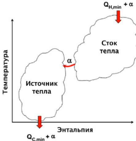
Рис. 2 - Организация тепловых потоков
