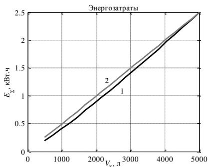
Рис. 3. Сравнение энергозатрат на кормораздачу в зависимости от суммарного объема раздаваемого корма (влажностью  $W = 80\%$ ) при оптимизации мощности электродвигателя насоса (кривая 1) и без оптимизации (кривая 2)
