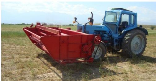
Рисунок 1 – Экспериментальный образец фронтальной навесной жатки для уборки трав
