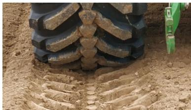
Рисунок 2 – Шина Michelin Evobib с адаптивным протектором
