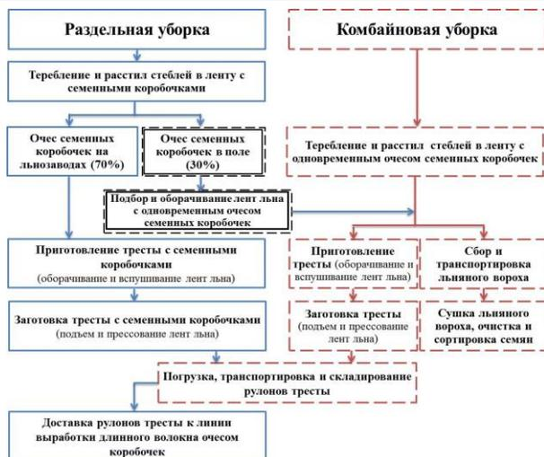
Рисунок 2 – Технологическая схема уборки льна
