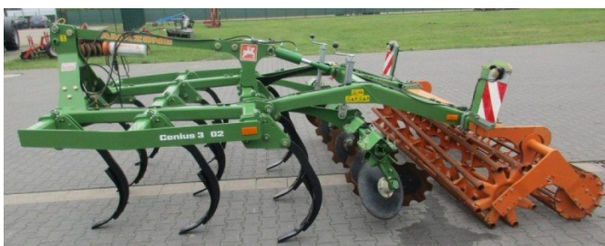
Рисунок 1. Мульчирующий культиватор Centius
