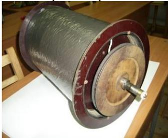
Рисунок 1 – Рабочий орган диэлектрического сепаратора лабораторного СДЛ-1 – диэлектрический барабан с бифилярной обмоткой и пленочным покрытием в лаборатории кафедры электротехнологии, подготовленный для предпосевной обработки мелких семян пряно-ароматических растений
