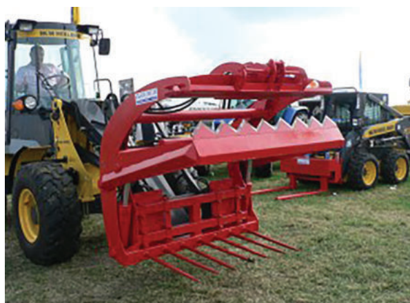
Рисунок 9 – Резчик-распаковщик рулонов (Keltec, Ирландия)
