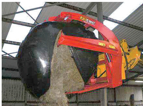
Рисунок 9 – Резчик-распаковщик рулонов (Keltec, Ирландия)
