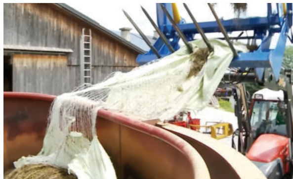
Рисунок 8 – Попадание упаковки рулона в бункер кормораздатчика
