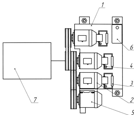
Полезная модель относится к обкаточно-тормозным устройствам и может быть использована для тормозных испытаний двигателей всех марок.
