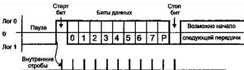
Рис. 1.20. Формат асинхронной передачи
