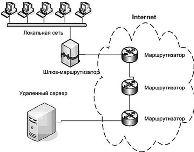
Рис. 2.22. Схема взаимодействия в сети Интернет
