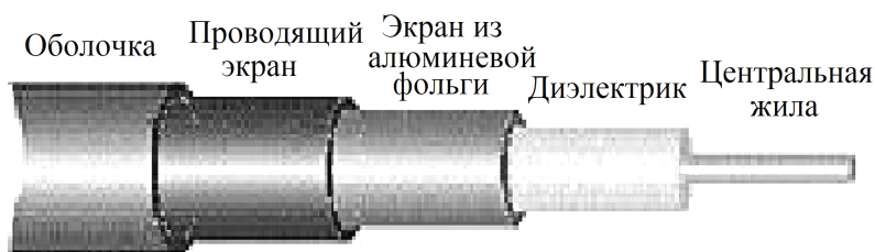
Рис. 1.41. Структура коаксиального кабеля
