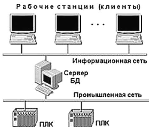
Рис. 3.11. Клиент-серверная архитектура SCADA-систем
