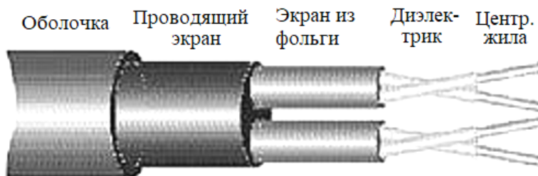
Рис. 1.42. Структура кабеля на витой паре
