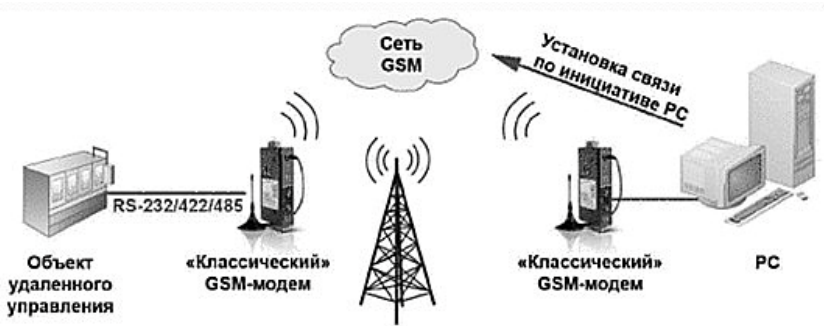
Рис. 2.24. «Классическая» топология системы удаленного управления оборудованием по сетям GSM
