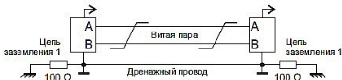
Рис. 2.8. Схема соединения по интерфейсу RS-485
