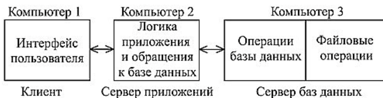
Рис. 2.27. Трехзвенная схема распределения частей приложения
