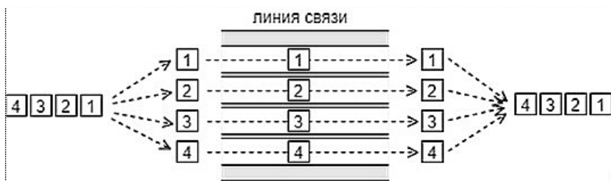
Рис. 1.19. Параллельная передача данных
