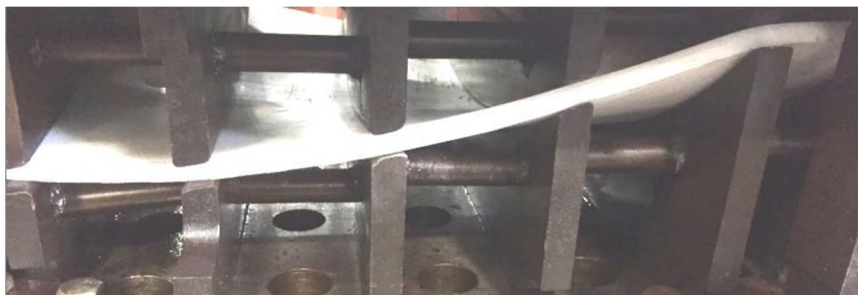
Рисунок 2. Внешний вид штампа с секционной конструкцией матрицы и пуансона в процессе листовой штамповки пластикового отвала
