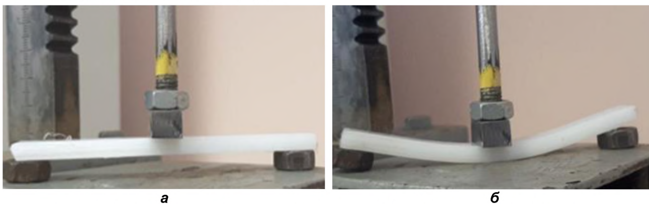
Рисунок 4. Пластиковые пластины в нагрузочном устройстве до (а) и после (б) формования
