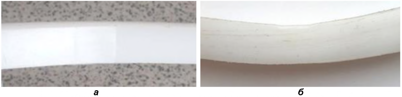
Рисунок 5. Отпечаток пуансона на поверхности отформованной пластиковой пластины: а – вид сверху; б – вид сбоку
