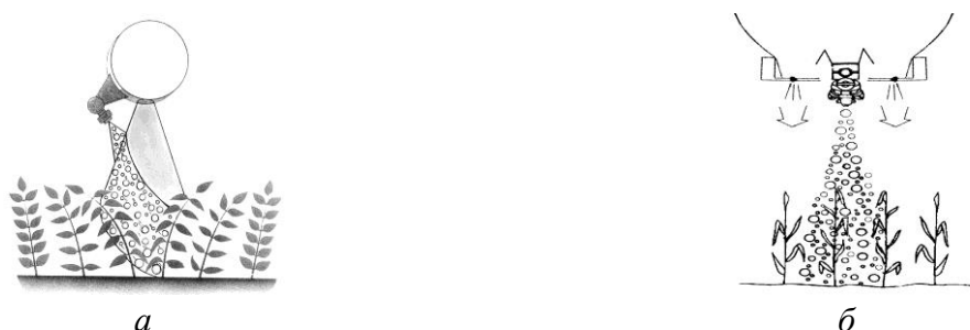
Рис. 3. Способы снижения сноса капель жидкости при использовании воздушных струй [2, 10]: а – схема осаждения капель воздушной струей, б – схема применения воздухоструйных защитных экранов
