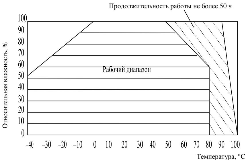
Рис. 4.7. Рабочий температурный диапазон датчика НН-4000 относительной влажности
