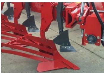
Рисунок 1 – Общий вид корпуса плуга с предплужником (а) и углоснимом (б)
