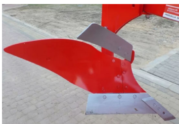
Рисунок 1 – Общий вид корпуса плуга с предплужником (а) и углоснимом (б)
