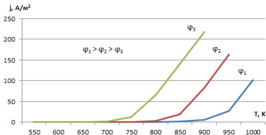
Рисунок 2 – Влияние потенциала выхода электрона из металла на плотность тока коронарного разряда
