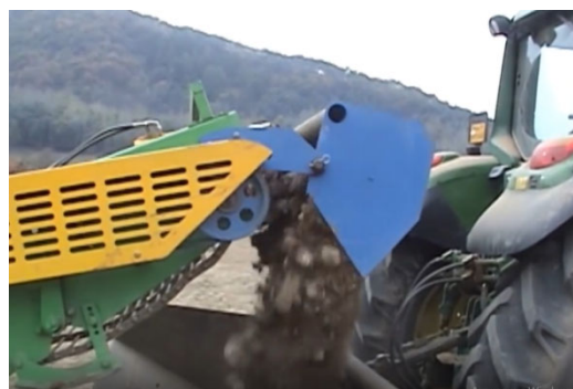
а – общий вид машины; б – процесс выгрузки камней из ковша Рисунок 3 – Сборщик камней навесной SH-1400JS
