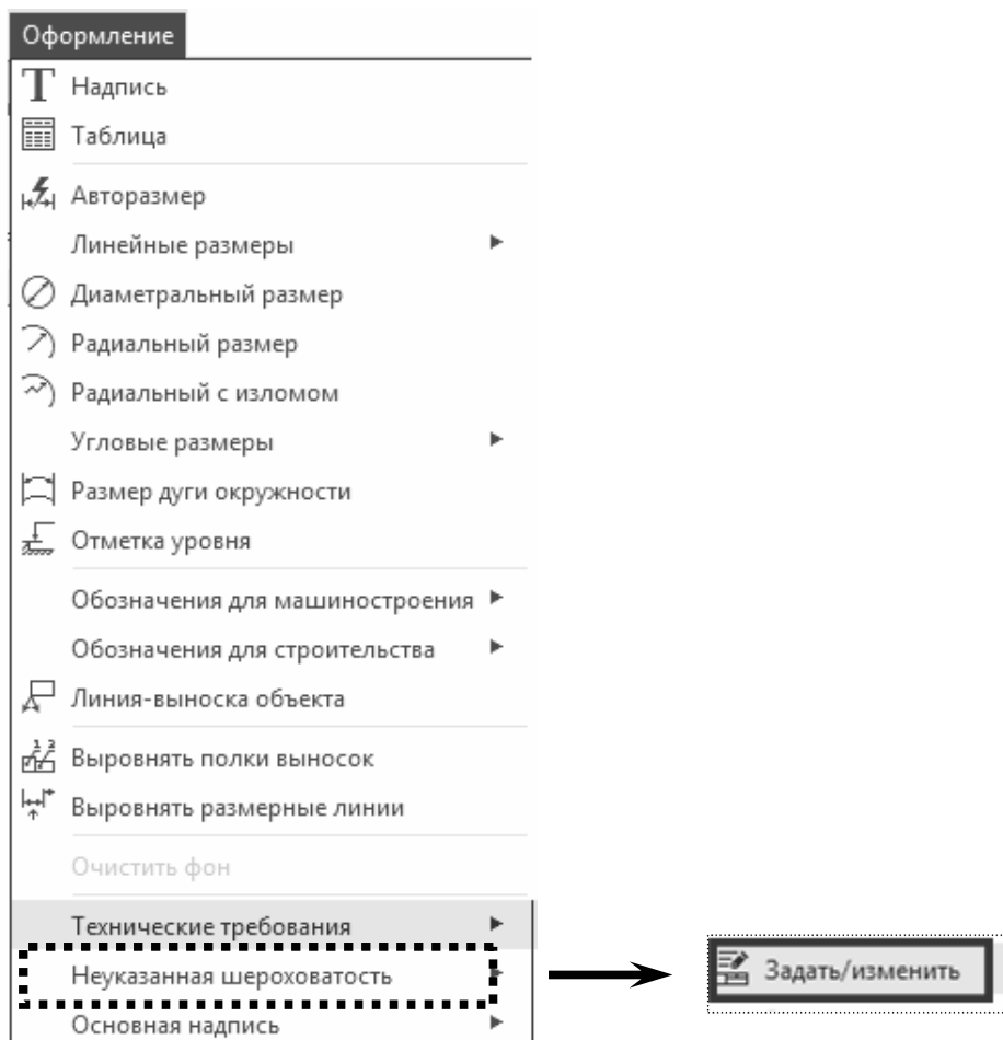
Рис. 3.14. Простановка знака неуказанной шероховатости
