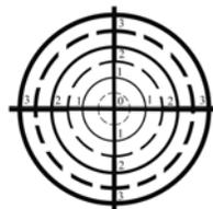
Рис. 4.19. Разбивка поперечного сечения воздухораспределительного рукава на равновеликие кольца
