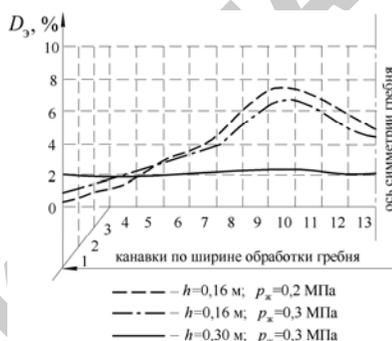
Рис. 5.6. График влияния высоты  $h$  установки и давления  $p_{ж}$  на входе в вихревую распылитель РВ 80-1.2 на распределение жидкости по ширине ленты
