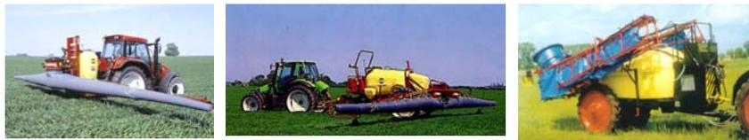
Рис. 3.5. Объемные опрыскиватели с ветрозащитными устройствами активного действия
