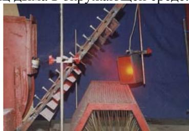
*Рис. 6.5. Воздействие ветрозащитной решетки на изменение направленного потока дыма*
