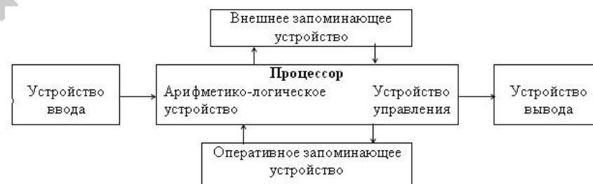
Рис. 1.1. Схема классической архитектуры ЭВМ
