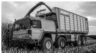
**Рисунок 2. Самосвал-силосовоз на шасси MAN Agrot Mover 8x8 с кузовом-емкостью JOSKIN Silo-Space**
