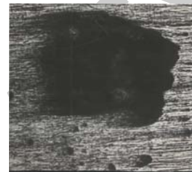
Рис. 5.42. Дефект поверхности стали после обработки шлифованием
