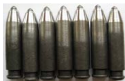
Рис. 5.36. Резцы РКС-1 после МАО (x 1,5)
