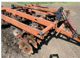
Рисунок 2 – Дисковая борона с установленным устройством для перераспределения веса
