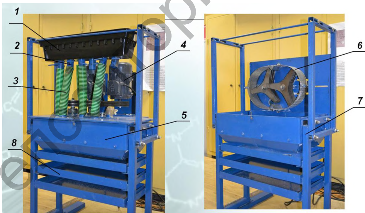
1 – приемный бункер; 2 – клапан-дозатор; 3 – загрузочный патрубок; 4 – электродвигатель; 5 – выгрузная воронка; 6 – камера измельчения, 7 – рама; 8 – лоток для проб
