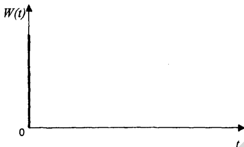
Рис. 2.10.2 Импульсная переходная функция безынерционного звена
