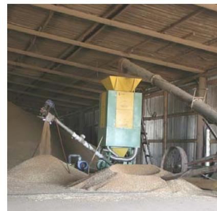
Рис. 2.8. Отечественная зерносушильная установка АСТ-3
