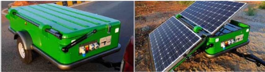
Рис. 7.12. Мобильная установка с фотоэлектрическим преобразователем для питания автономных устройств в местах с ограниченным электроснабжением
