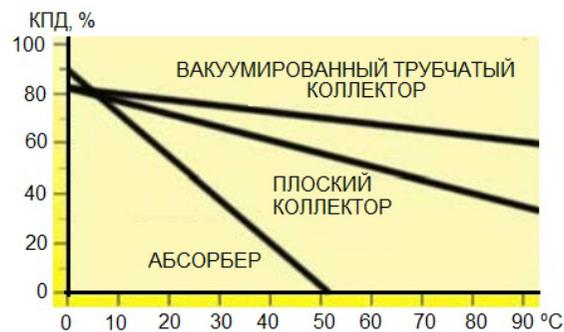
Рис. 7.5. Зависимость КПД солнечных коллекторов в различных типов от разности температур внутри трубок коллектора (теплоносителя) и окружающей среды
