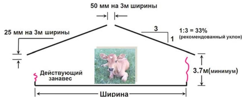
Рис. 4.6. Типовая конструкция помещения для содержания КРС
