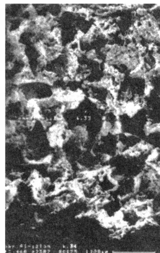
Рис. 3. Структура литого проницаемого материала на основе алюминия. Хрупкий излом. \times 100
