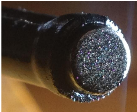
Рис. 2. фотографія робочої поверхні постійного магніта з осажденими на ньому ферромагнітними частинками
