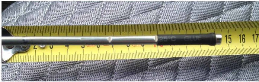
Рис. 1. Фотографія магнітного щупа
