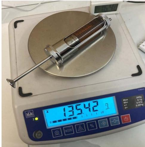
Рис. 1. Оборудование для экспресс-метода определения плотности моторного масла
