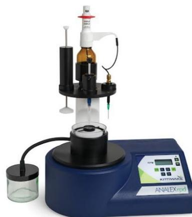
Рисунок 7 – Аналитический феррограф *Kittiwake ANALEXrpdFG-K19026-KW*
