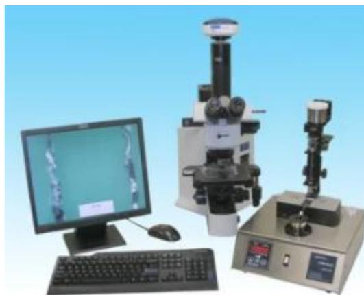
Рисунок 9 – Аналитическая феррографическая лаборатория SpectroT2FMQ500
