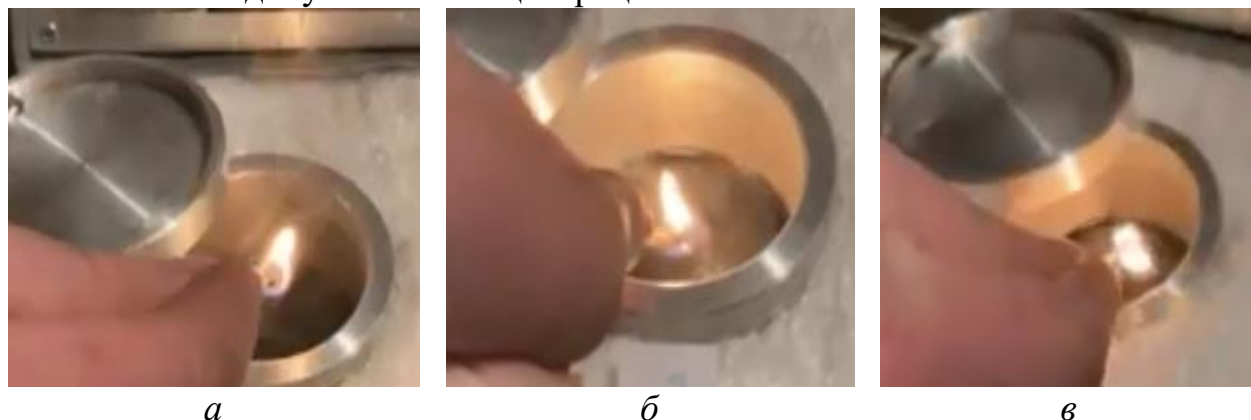
Рисунок 6 – Оценка наличия топлива в моторном масле
