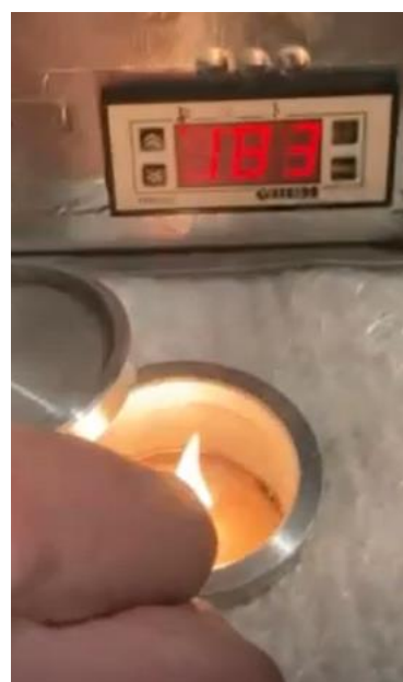
Рисунок 4 – Последовательность операций при оценке наличия топлива в моторном масле
