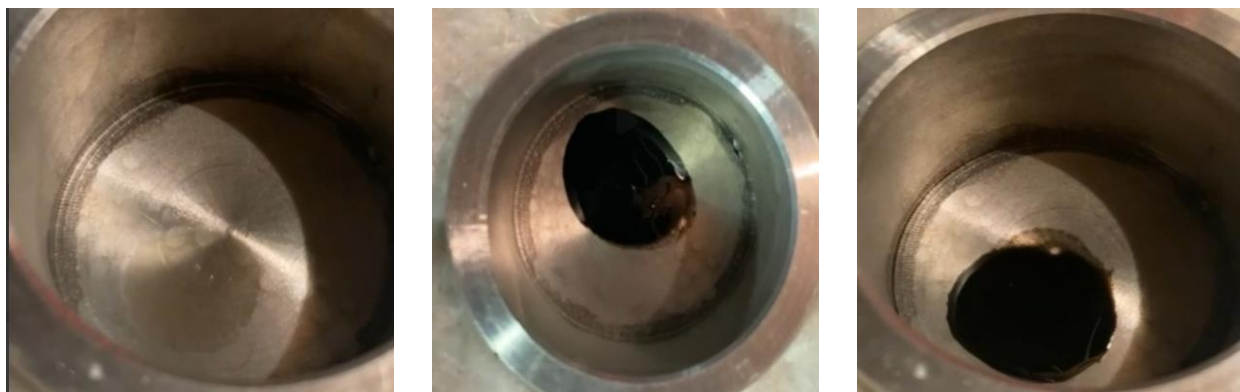
Рисунок 3 – Результаты экспресс-теста на содержание воды: а – свежего масла; б – работающего масла; в – отработанного масла
