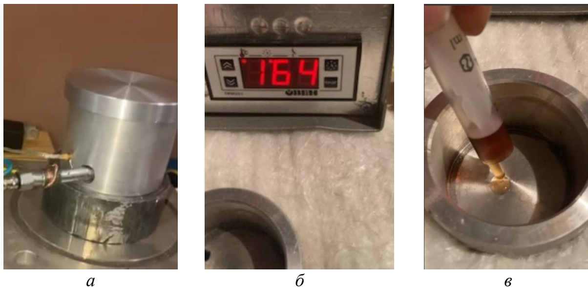
Рисунок 2 – Определение наличия воды в моторном масле: а – внешний вид электротигля; б – фиксация температуры нагрева; в – нанесение капли масла на разогретую поверхность
