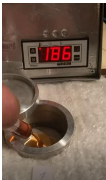
Рисунок 4 – Последовательность операций при оценке наличия топлива в моторном масле
