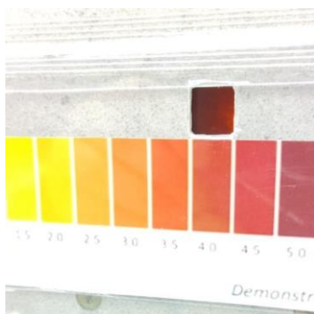
Рисунок 3 – Результаты апробации метода колориметрии с использованием различных кювет моторных масел Лукойл Авангард 10W40 с различной наработкой:
